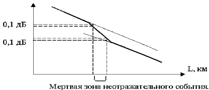
Рис.49. Определение мертвой зоны для неотражательного события.
