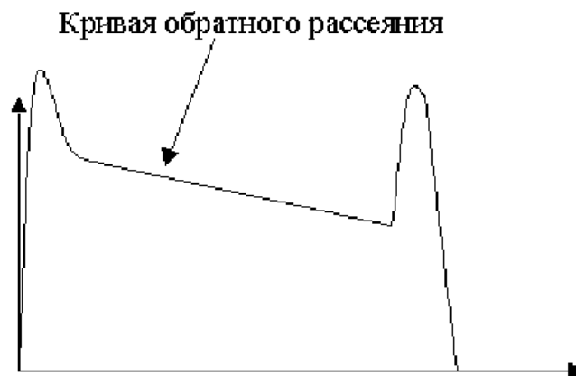
Рис.47. Рефлектограмма исправной линии
